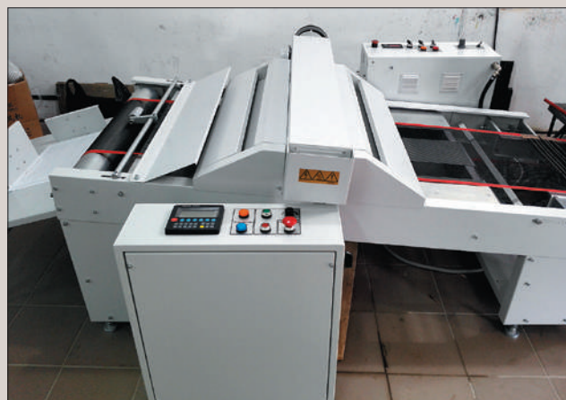
УФ-облучатель FOTON для конвейеров для УФ-лакирования
