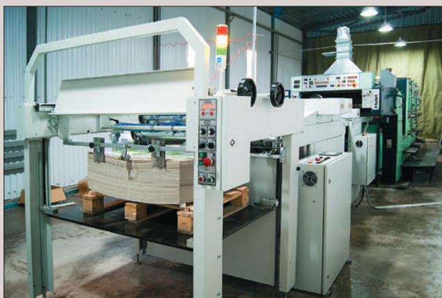
Курск: автоматическая линия STREAMLINER 1050 для УФ-лакирования картонной упаковки
