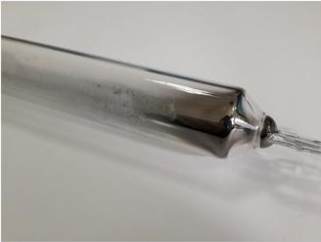
Появление зеркального налета в области электродов внутри колбы ультрафиолетовой лампы
