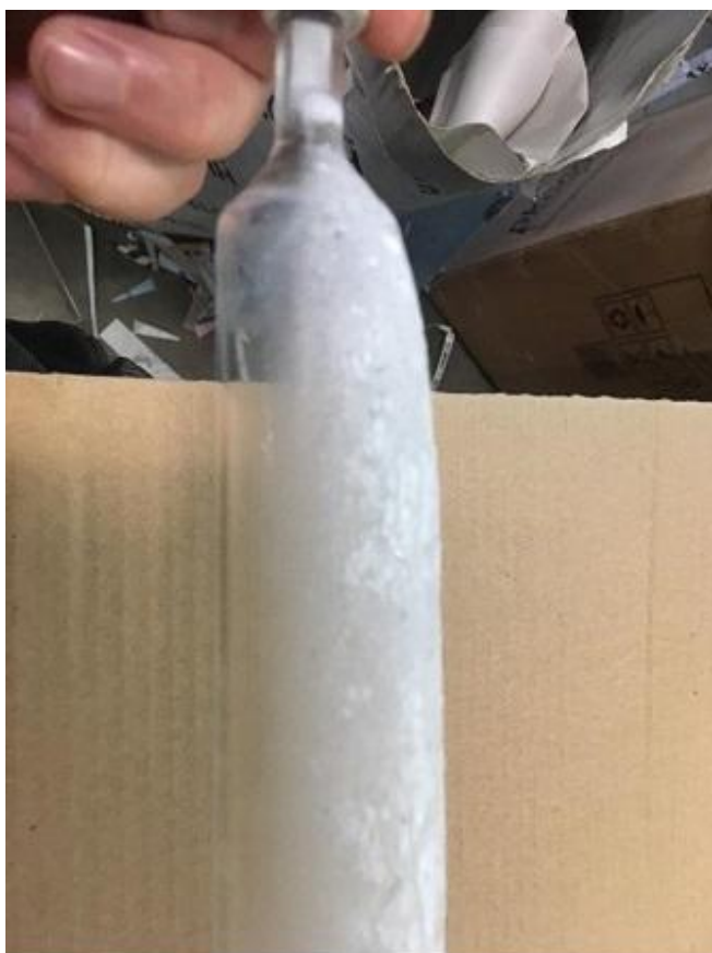
Расстеклование материала колбы УФ-лампы из-за сильного загрязнения противотмарывающим порошком
