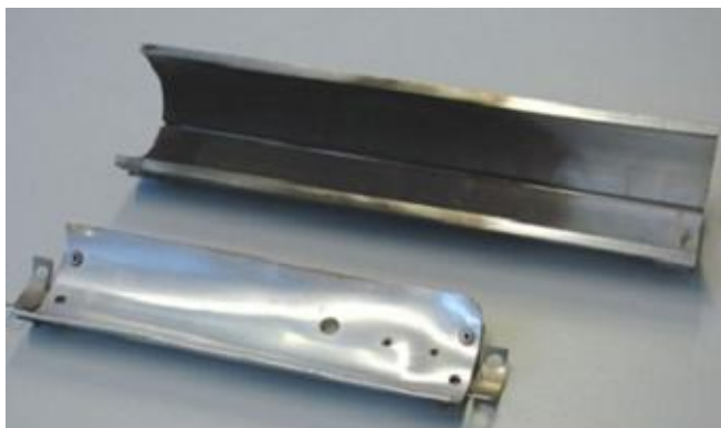
Помутнение и загрязнение отражающих поверхностей рефлектора ультрафиолетовой лампы
