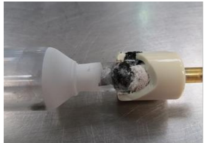
Повреждения керамического цоколя ультрафиолетовой лампы в результате перегрева
